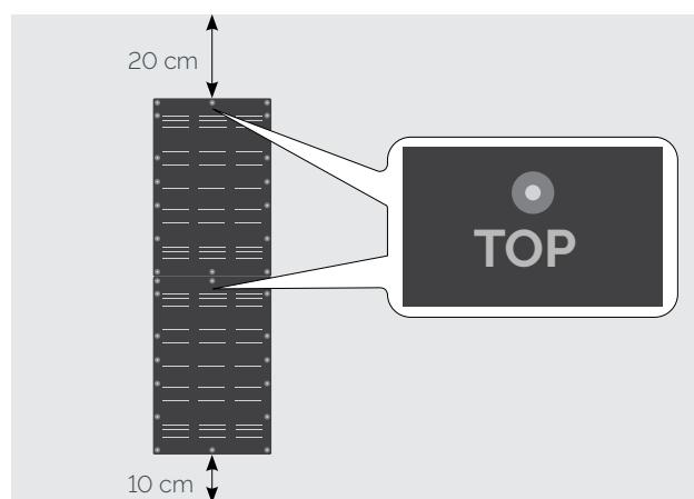
Wir empfehlen die Verwendung von 6 Schrauben je Gitter.
